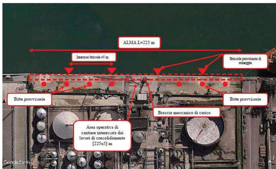
Fig 78 - Progetto definitivo - Proposta linea di accosto per ormeggio
